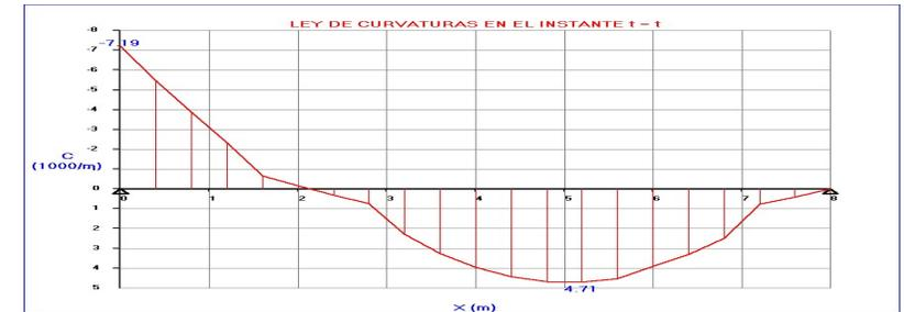
**Campo de aplicación:** Estructuras de hormigón armado y pretensado. Considera los efectos diferidos debidos a la fluencia, retracción y fisuración. Calcula la redistribución temporal de esfuerzos, curvaturas, flechas y reacciones.
